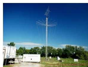
Antenne large bande pour tests électromagnétiques
